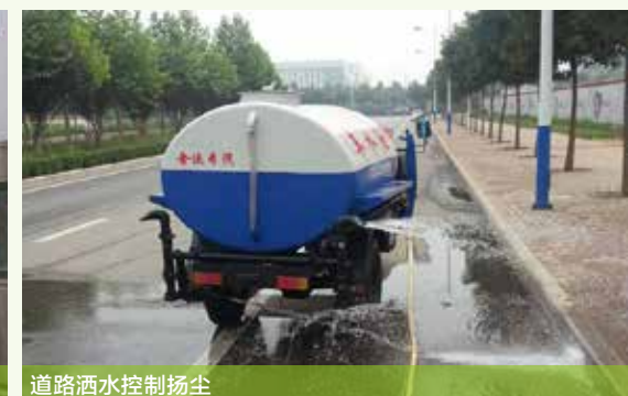
道路洒水控制扬尘
